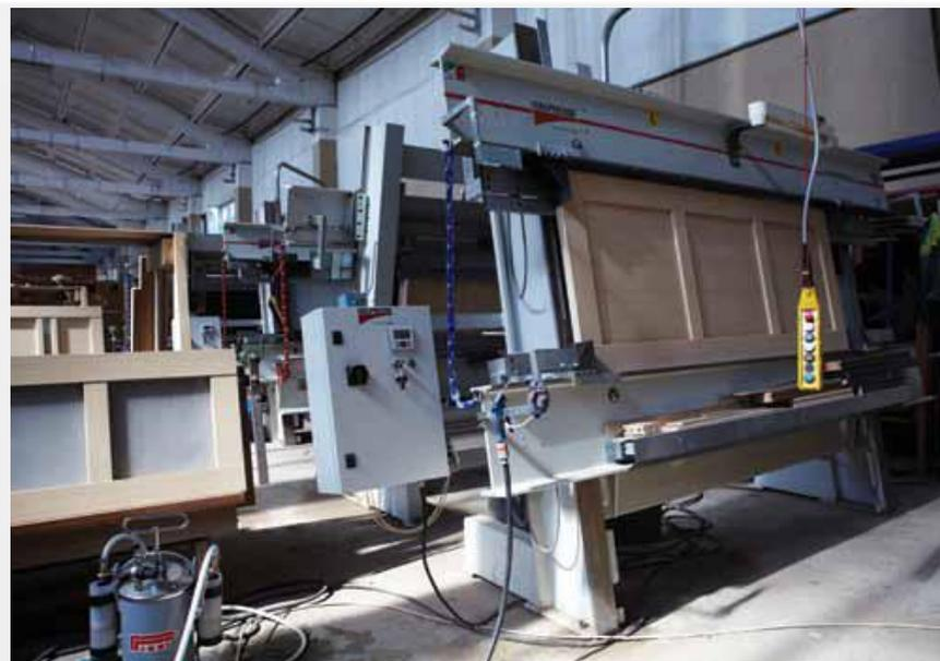
Прессование стоевых деталей происходит с использованием **высокочастотного прессы Dimter** от одного из ведущих производителей немецкой фирмы **Weining**
