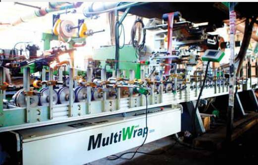
Дверные полотна обрабатываются на окутывающем комплексе немецкого производителя **Düspohl**
